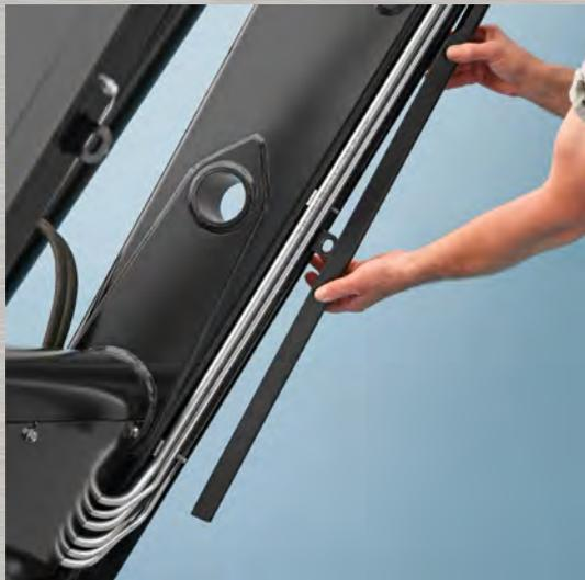
Дополнительное преимущество профиля балансира: гидравлические шланги (защищенные кожухами) монтируются под балансиром. Масло подается вплоть до клапана „МСV“ в стальных шлангах.
