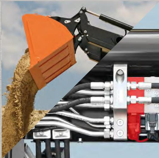
Функция быстрого опрокидывания фронтальных погрузчиков серии „VX“ дополнительно ускоряет опорожнение рабочего устройства. Клапан для выполнения этой функции также установлен в системе 12„MCV“:
