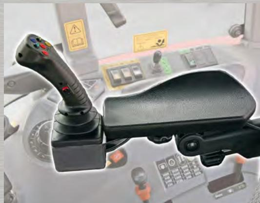
Устройство управления „ELC“ с одним рычагом представляет собой электрический пропорциональный клапан управления функциями погрузки и дополнительными клапанами. Дополнительно можно установить регулируемый подлокотник с пятью положениями.
