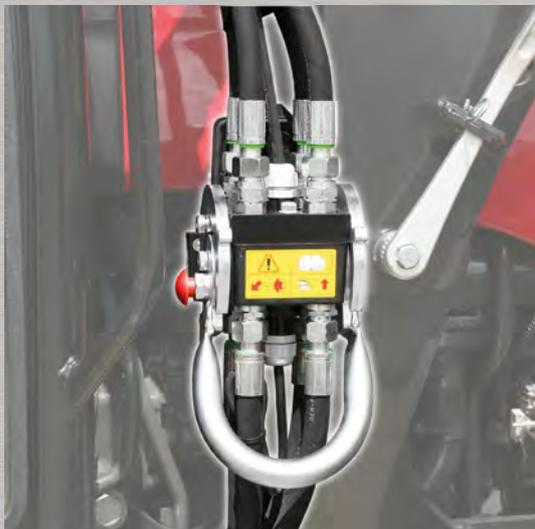
Многофункциональный шланговый соединитель „Synchro-Lock“ облегчает и ускоряет соединение гидравлических шлангов фронтального погрузчика. Предлагается и в исполнении с встроенной электромuftой.
