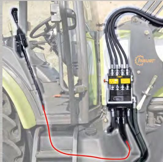
Управление всеми функциями одним рычагом. Выполнять погрузочные работы можно еще эффективнее и рациональнее благодаря устройству управления с одним рычагом. Моноблочный клапан присоединяется непосредственно к гидравлической системе трактора.
